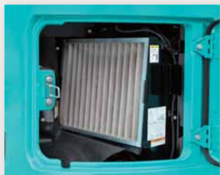
左后方ガード:iNDRフィルタ/バッテリー/冷却機器/ウォッシュタンク/他
