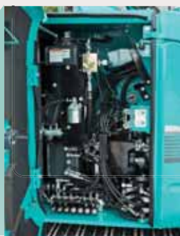
右サイドガード: コントロール/バルブ/燃料フィルタ/ N&Bセレクト/MALTIコントロール/他
