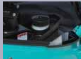
取り外して丸洗いできる樹脂製燃料タンク。
