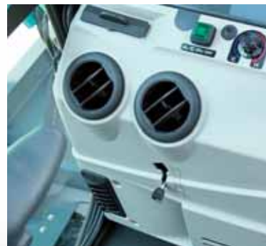
新型キャブではエアコンを標準設定。夏の猛暑日も真冬日も快適に作業可能。エアコンユニットは足元右配置で後方視界もワイドです。また、オプションでヒータを設定しています。
