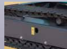
泥落ちのよい片流れローラフレーム。
