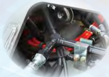
油圧損失を抑えるY字配管
