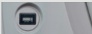
アワメータ キャブの外側からも確認できる位置に設置。
