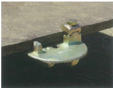
①吊している鉄板に仮留ボルトで小判君の下部をセットします。簡単に取付られます。
