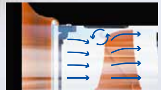
風の渦によって余分な抵抗と共振音が発生
