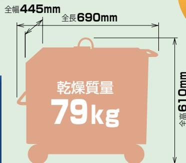
小型軽量の高効率磁石式高周波発電機の開発と、ボンネット内の構造や部品の見直しにより、小型軽量化を追求。
