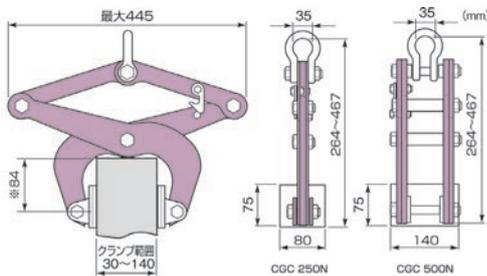
※印寸法は、適用コンクリート厚みが最大の時です。
