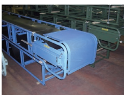
◎テール部安全カバー テールフレームの後面
