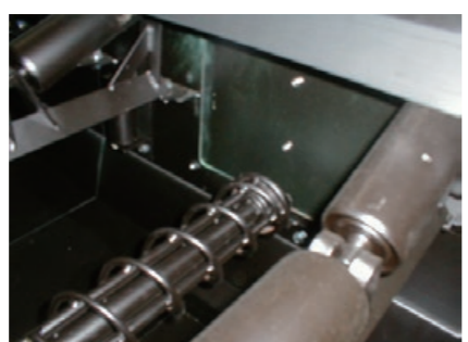
◎スパイラルリターンローラ 付着性の搬送物を運搬する時
