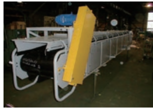
ギヤードモータ駆動(2分割チェーンカバ)
