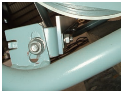
◎ヘッドクリーナ ニューライト式 ウレタン・チップ式も取付可能
