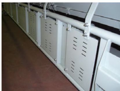
◎サイドカバー コンベヤフレームの安全カバー
