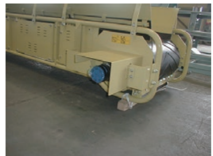
◎油圧モータ駆動 重機の油圧を利用
