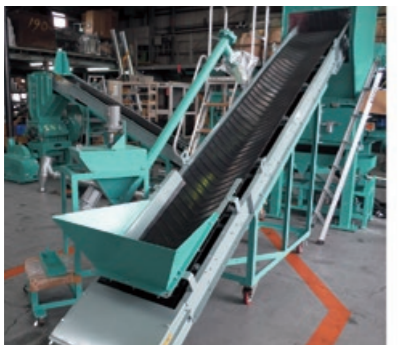
7 廃電線搬送コンベヤ
