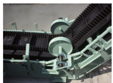
◎急傾斜コンベヤ 下部変角部の片持ちプーリ
